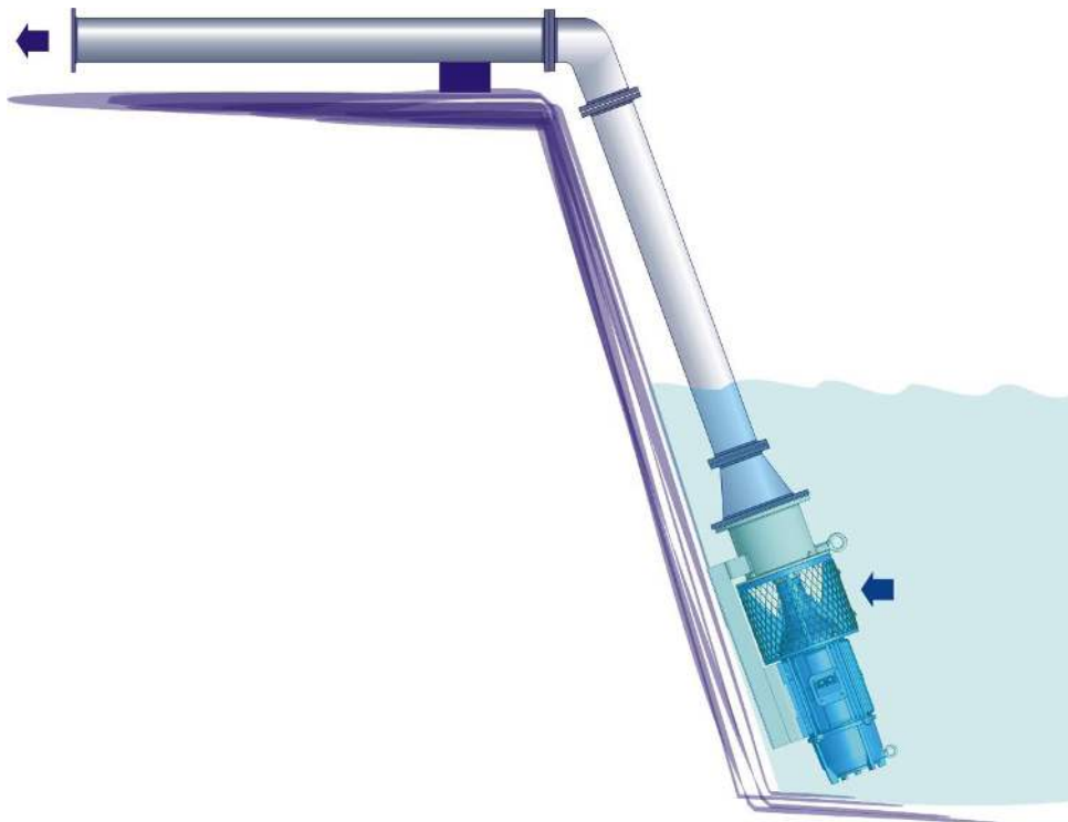
Figura 09 – Forma de instalação com uma bomba instalada submersa e inclinada.
