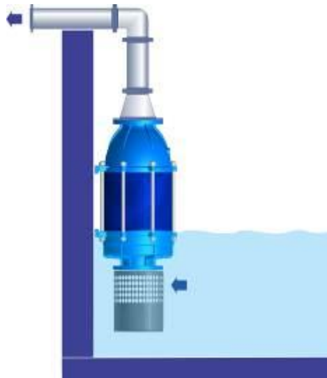
Figura 16 - Bomba operando parcialmente sumergida, con la succión sumergida.
