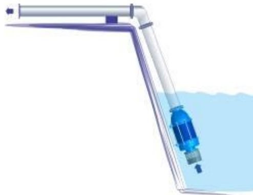
Figura 11 - Bomba Anfibia operando sumergida.
