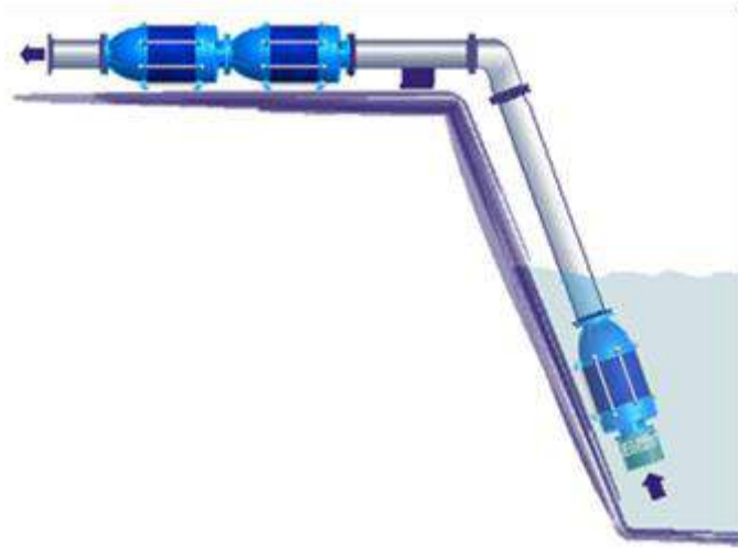
Figura 13 – Forma de instalação de três bombas modulares em série somando pressões, sendo uma submersa alimentando outras duas bombas fora da água
