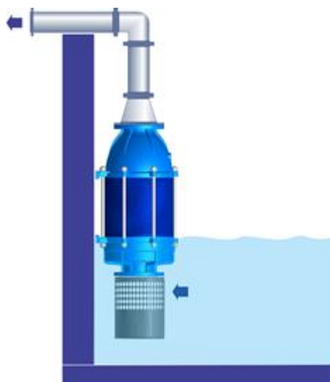
Figura 16 – Forma de instalação com uma Bomba operando parcialmente submersa, ou seja, somente com sua sucção submersa
