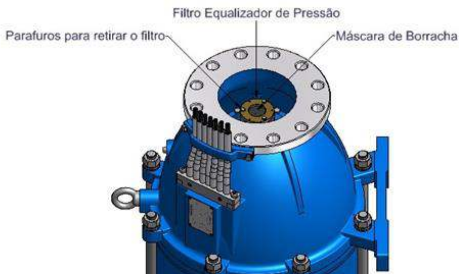
Figura 19 – Detalhe do Filtro Equalizador de Pressão
