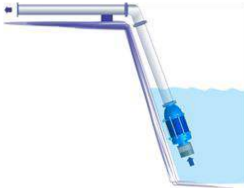
Figura 11 – Forma de instalação de uma bomba Anfíbia trabalhando submersa
